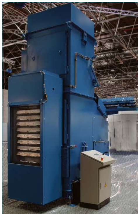
Masselvorwärmung IPU (Blick auf die Beladeseite) - Ingot Preheating Unit IPU (seen from the loading side)
