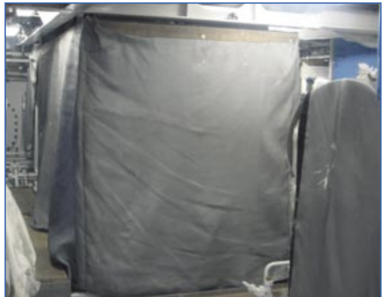
Generatorabdeckung für Instandhaltungsarbeiten bis 1300°C
